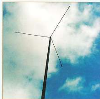
Toploading bestaande uit drie sprietten, kan ook uit meer sprietten bestaan of als wiel worden uitgevoerd.
